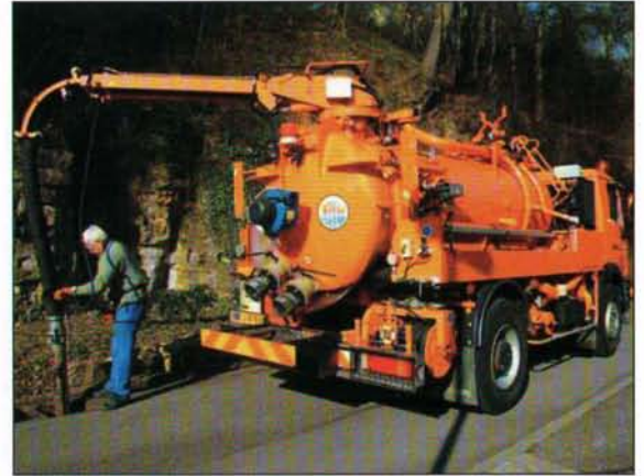
Tägliche Routinearbeiten: Entleerung der Straßeneinläufe
