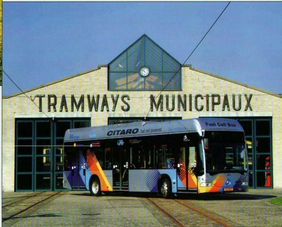
Hightech im Dienste von Low Emission: Der Brennstoffzellenbus wird mit Wasserstoff angetrieben und stößt nur Wasserdampf aus.
