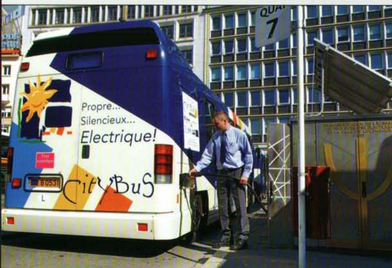
Hybridbus beim Zwischentanken am Hauptbahnhof. Binnen 12 Minuten kann der Akku zur Hälfte nachgeladen werden – das reicht für weitere 20 Kilometer.
